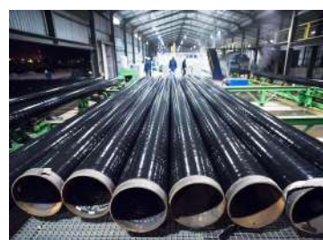
Трубы в ВУС изоляции
