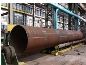
Трубы из обечаек
